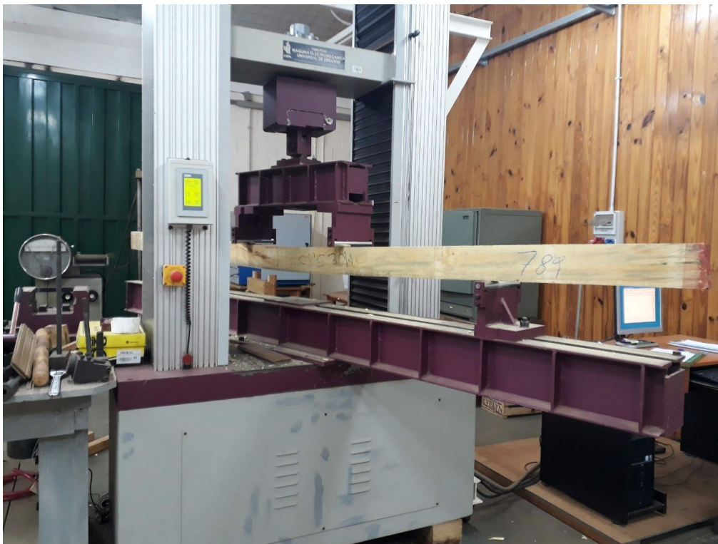
Fig. A.5 Ensayo destructivo. Obtención del MOE_e de tablas mediante la máquina universal de ensayos.
