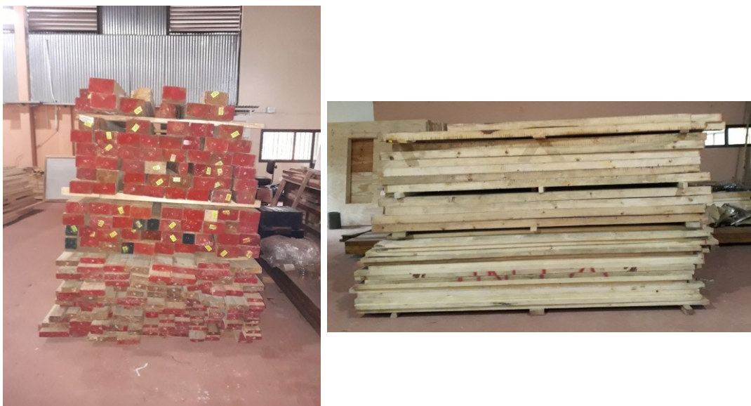
Fig. A.4 Vistas de tablas centrales y laterales para ser sometidas a la máquina universal de ensayos.
