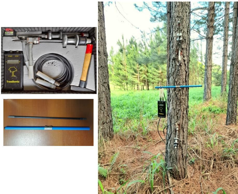
Fig. A.3 Herramientas no destructivas utilizadas. Instaladas sobre árbol en pie (derecha). Detalle del TreeSonic (izquierda-arriba) y barreno de Pressler (izquierda-abajo).
