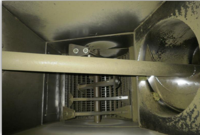
Figura II-8. Detalle vista superior del molino de martillos locos de la canchadora.
