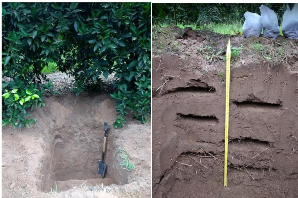
Figura N° 13. Calicata; sobre un suelo Cuartzipsament óxico, serie Yuquerí grande, en área experimental.
