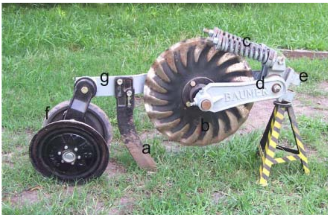
Figura 2.3.3: Accesorio de labranza evaluado en el ensayo. Órganos activos: (a) escarificador de arco rígido, (b) cuchilla labrasurco; órganos de fijación del conjunto: (d) brazo regulable porta cuchilla, (e) brida de anclaje, (g) bastidor; (f) ruedas tapadoras/compactadoras y (c) resortes de compensación
