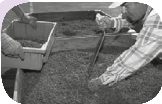
Figura 20. Los inspectores utilizan una sonda de resorte de acero templado de 24 pulgadas para facilitar el muestreo. La sonda permite a los inspectores levantar pasas y extraer una muestra que se encuentre debajo de la superficie.
