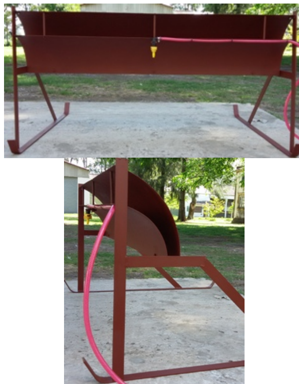
Figura 24: vista frontal y lateral del escudo protector, la estructura de sostén y la ubicación de la boquilla.
