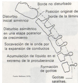
Figura 1: Diagrama de desintegración de borde, Matthews (1979).
