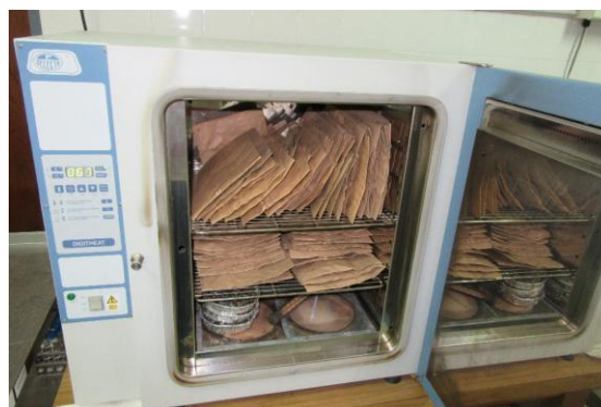
Figura 65: Determinación de materia seca en estufa a 65-70 °C.
