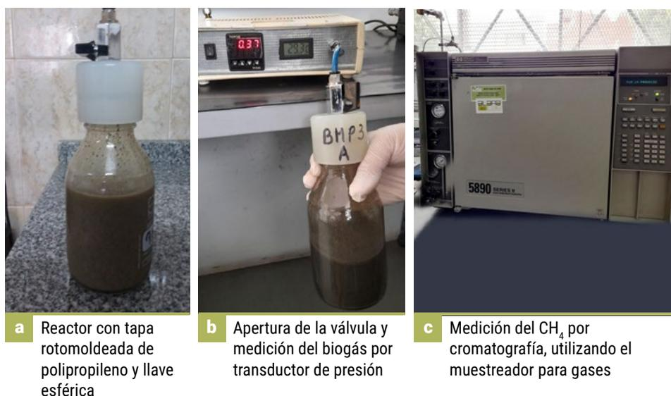
También, el ensayo de PBM se lleva a cabo en los reactores mostrados en la **Figura 8**, los cuales contienen (a diferencia del diseño anterior), un muestreador del líquido. Este tipo de reactores son utilizados cuando se requiere monitorear la evolución del proceso anaeróbico a través de los parámetros como AGV o alcalinidad o bien cuando se desea estudiar el comportamiento de compuestos inhibitorios.
