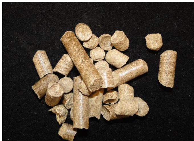
Figura 5 - Peletizado de hojas de ajo para aprovechamiento como combustible sólido
