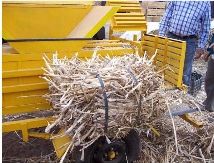
Figura 4 - Enfardado de hojas de ajo para reducción de volumen y traslado
