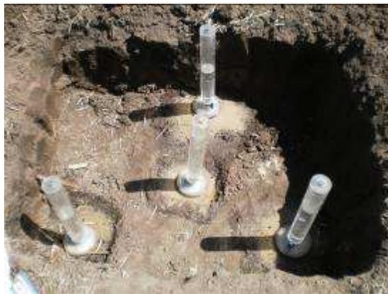
Ilustración 2. Foto tomada durante la caracterización de los suelos. Determinación de Infiltración en el horizonte thapto
