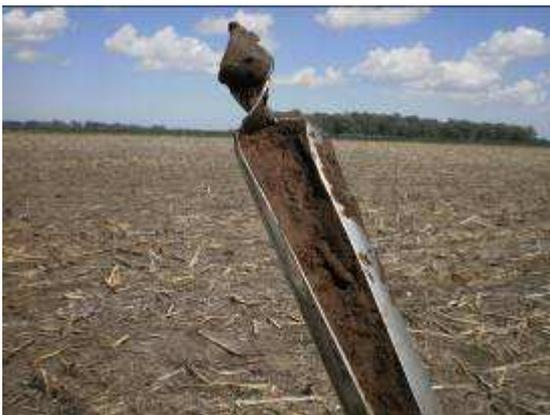
Ilustración 1. Fotos tomadas durante la caracterización de los suelos. Barreno con muestras del horizonte thapto.
