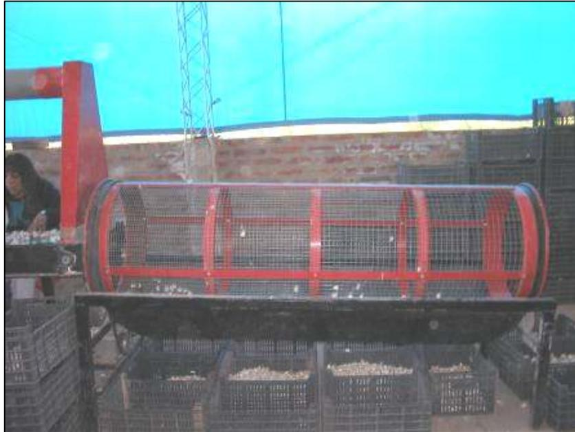
Figura 15 - Clasificadora de dientes lineal de malla.
