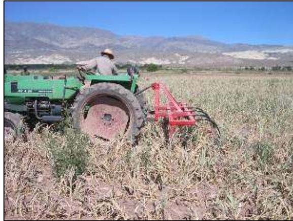
Figura 30 – Arrancado con cuchilla laminar
