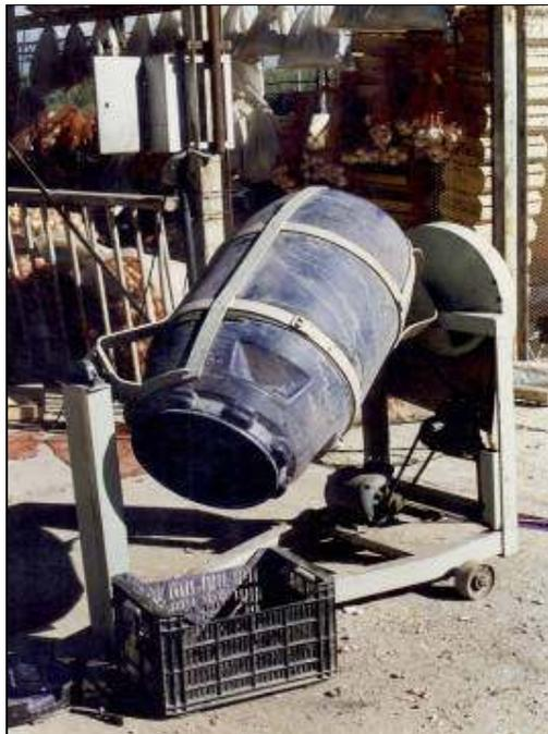
Figura 18 - Tambor excéntrico de accionamiento eléctrico para tratamiento de diente-semilla
