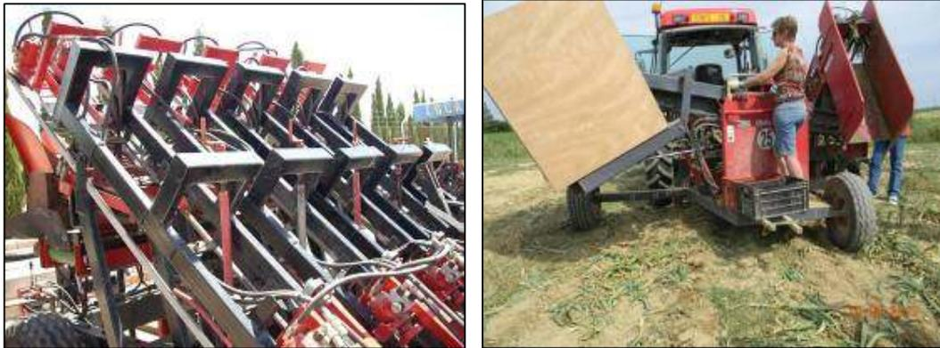
Figura 33 – Arrancadora destalladora
