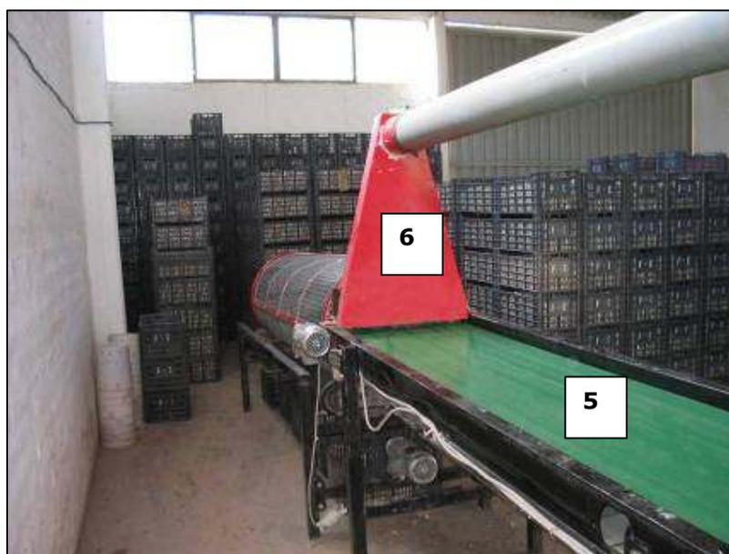
Figura 4 - Cinta de inspección de la desgranadora de bulbos
