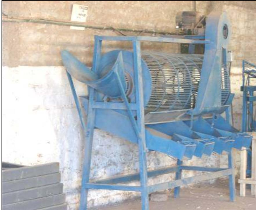
Figura 14 – Clasificadora de dientes por barras paralelas.
