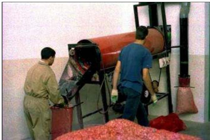
Figura 19 - Cilindro continuo de accionamiento eléctrico para tratamiento de diente-semilla
