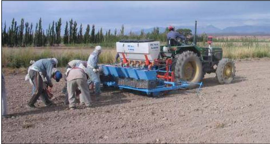
Figura 28 – Plantación mecánica con corrección manual
