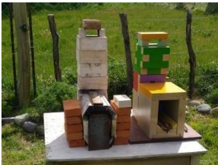
Imagen 29. Cámaras premoldeadas, primera versión en material refractario (izq.) y segunda versión en maqueta (der.), presentada en el concurso Innovar 2019
