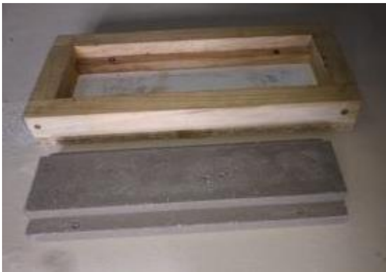
Imagen 26. Pieza premoldeada y su molde de madera. Trevelin, Pcia de Chubut. Foto: E. Rocha
