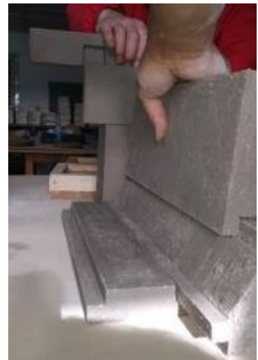
Imagen 27. Pieza premoldeada y su molde de madera. Trevelin, Pcia de Chubut. Foto: E. Rocha
