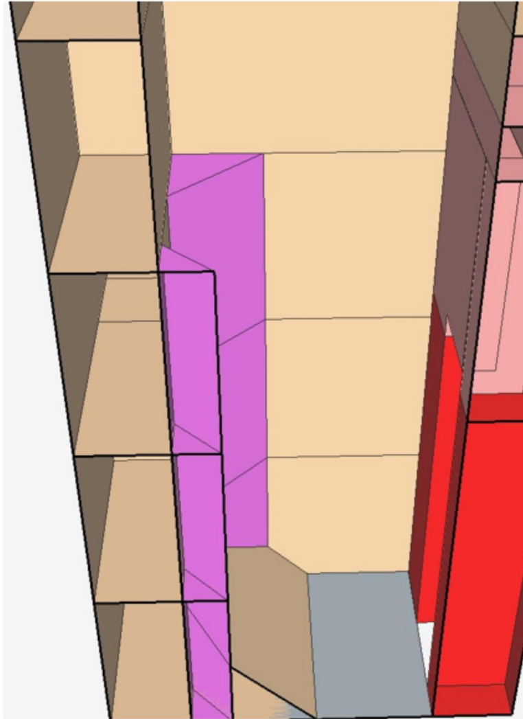
Imagen 8. Deflectores en torreta cuadrada
