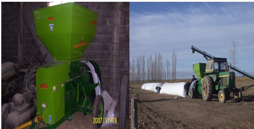
Figura 2 y 3. Foto Izq. Moledora-embutidora de SGHmz. Foto Der. Molido-Embutido de grano húmedo de maíz en el silo bolsa.
