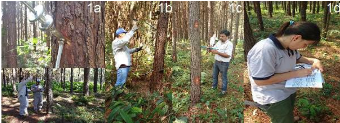
Fig. 1a y 1b: Procedimiento de medición del tiempo de propagación de la onda acústica. 1c y 1d: Extracción, identificación y acondicionamiento de tarugos.
