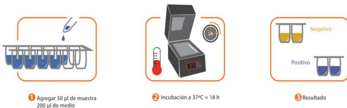
Figura 19. Procedimiento para evaluar la presencia de quinolonas mediante Kit Equinox.
