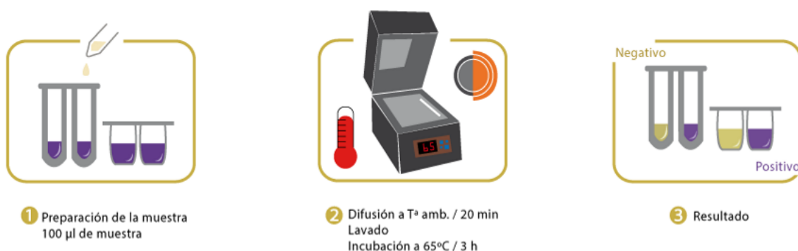
Figura 18. Procedimiento para evaluar la presencia de sustancias inhibidoras del crecimiento bacteriano mediante Kit explorer.
