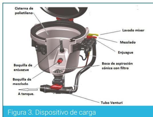
Figura 3. Dispositivo de carga
