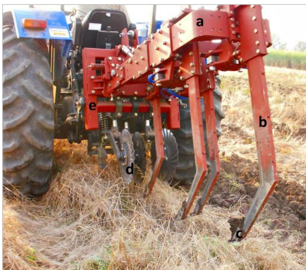
FIGURA 2.1: Vista trasera en posición de transporte del prototipo. Referencias: a: Bastidor; b: Timón; c: Púa (órgano activo); d: cuchilla de corte; e: Torre de acoplamiento.
