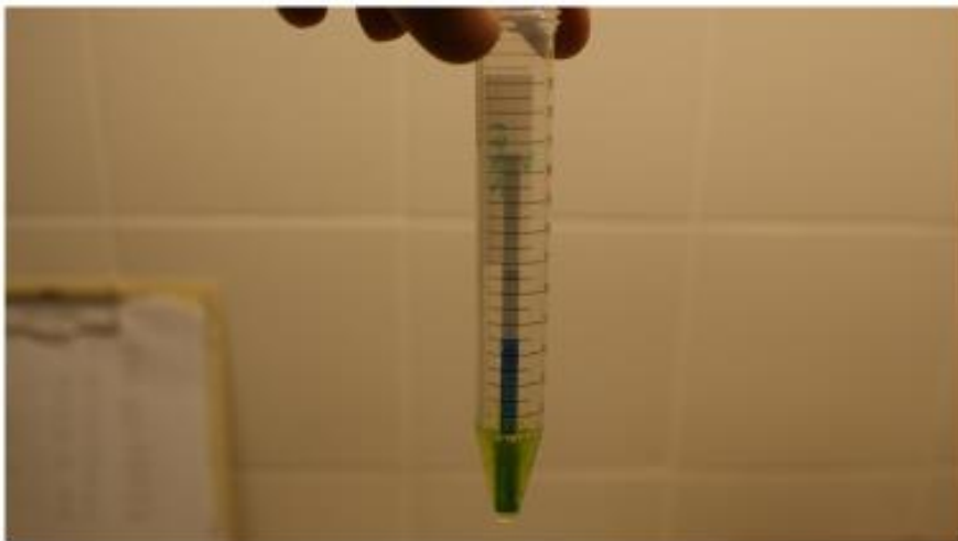
Paso 17. Esperar la aparición de reacción en las zonas de testeo y control. La tira no debe permanecer en la solución por más de 5 minutos.
