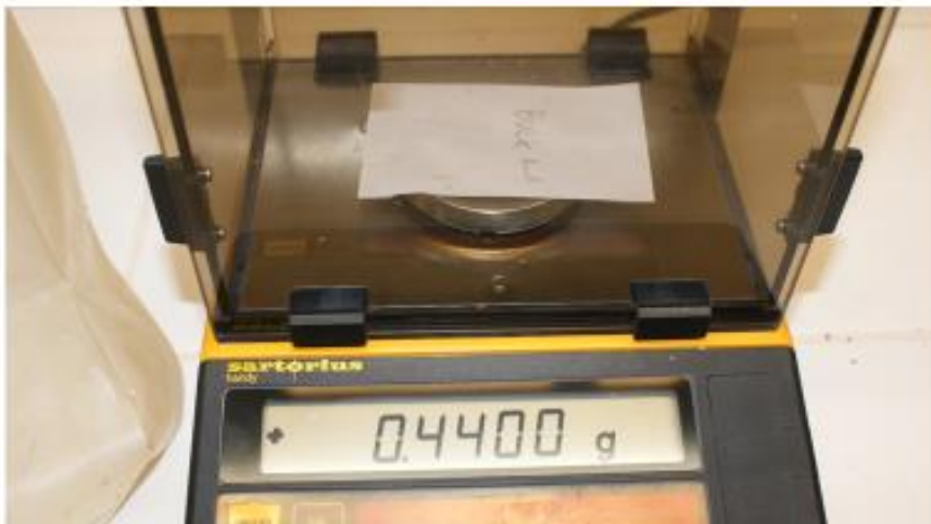
Paso 7. Pesar el sobre conteniendo las hojas muestreadas del Bulk. Este peso será el peso neto de las hojas.
