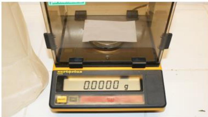
Paso 5. Tarar la balanza con el peso de un sobre vacío.
