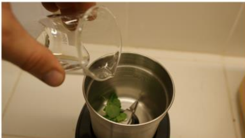
Paso 11. Agregar agua destilada al molinillo. Debe agregarse 20 veces (en ml) el valor del peso neto en gramos de las hojas
