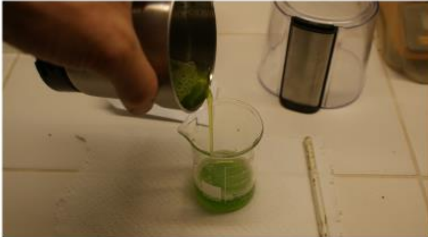
Paso 14. Verter la muestra molida en un vaso de precipitado y dejar reposar unos segundos.
