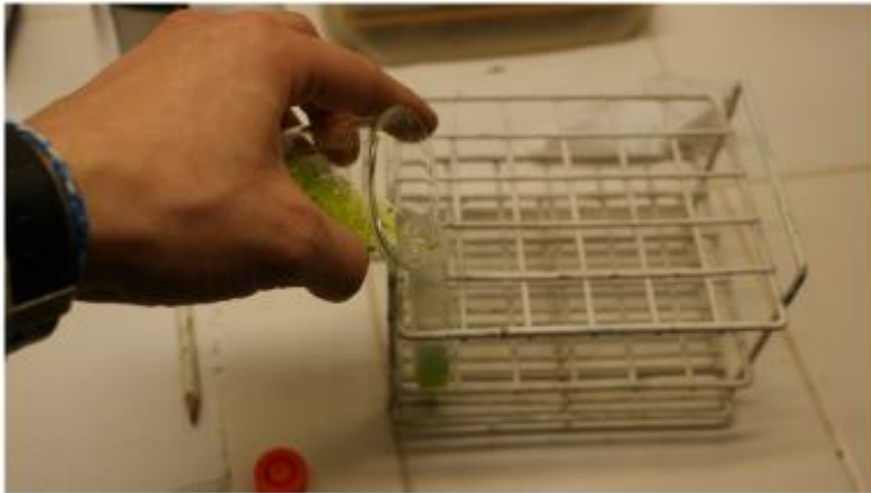
Paso 15. Verter 2 a 2,5 ml de la muestra en un tubo falcon de 15 ml.
