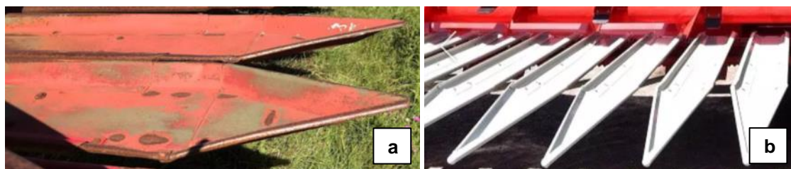
Figura 9. a) Vista lateral de un par de bandejas del cabezal girasolero Maizco 1997, utilizado en el ensayo. b) Vista frontal de las bandejas de un cabezal girasolero Maizco de última generación.
