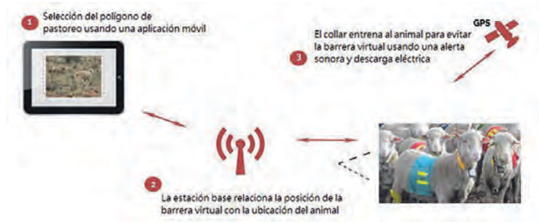
Figura 3. Esquema del funcionamiento del alambrado virtual con tecnología GPS.
