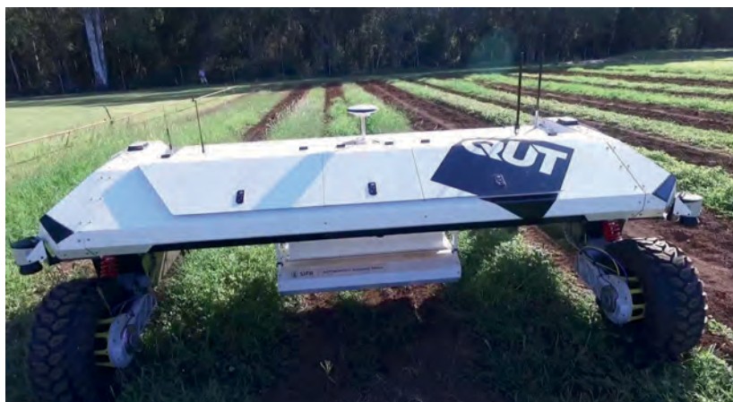
Foto 1. Robot autónomo utilizado para control químico o mecánico de malezas.
