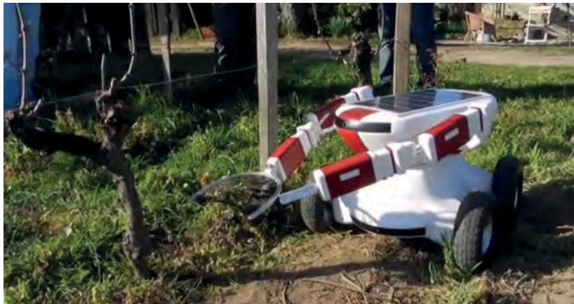
Foto 2. Robot autónomo para poda del cultivo de vid.
