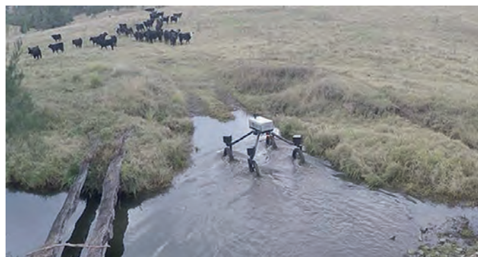
Foto 3. Robot autónomo SwagBot desarrollado por la Universidad de Sydney. Fuente: Australian Centre for Field Robotics, University of Sydney.
