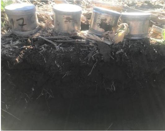
Foto 2: Muestreo de suelo a diferentes profundidades para determinar porosidad total, conductividad hidráulica y densidad aparente.
