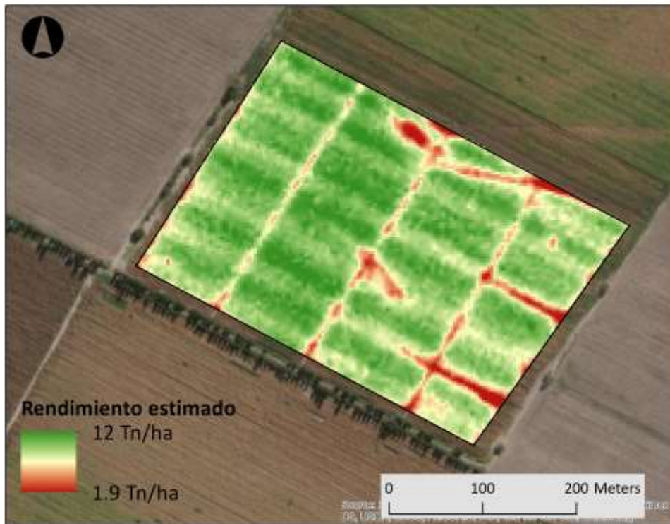
Figura 5. Mapa de rendimiento estimado a partir del NDVI en el momento de floración (R1)
