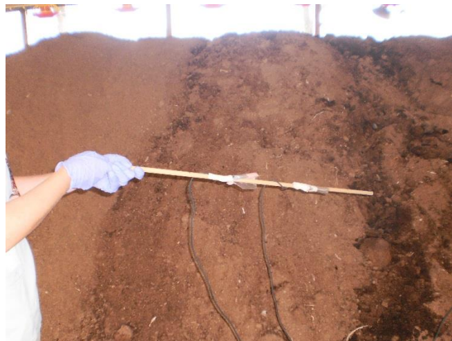
Foto 4. Varilla donde se fijaron los sensores.
