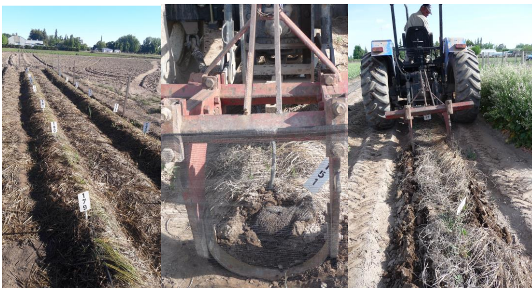
Figura 27. Surco listo para cosecha. Cosecha semi mecanizada, con desplantador de estacar. Detalle de la cuchilla pasando por debajo de la manta de plantación.
