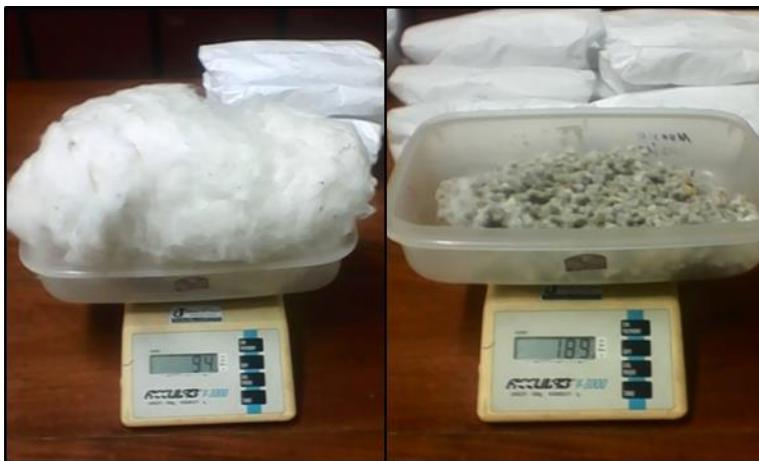
Figura 18. Peso de las muestras de algodón desmotado en el laboratorio.
