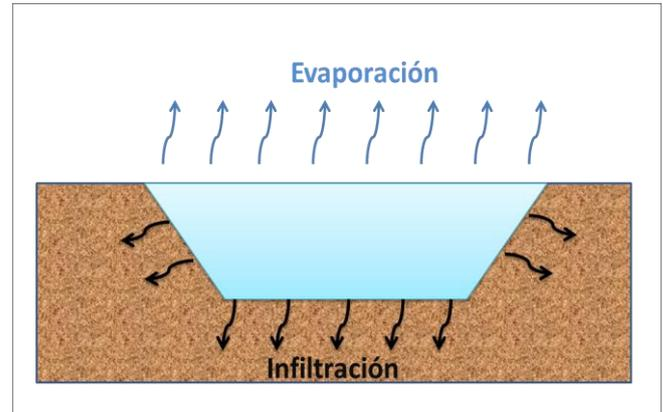
Figura 1. Pérdidas de agua por evaporación e infiltración
