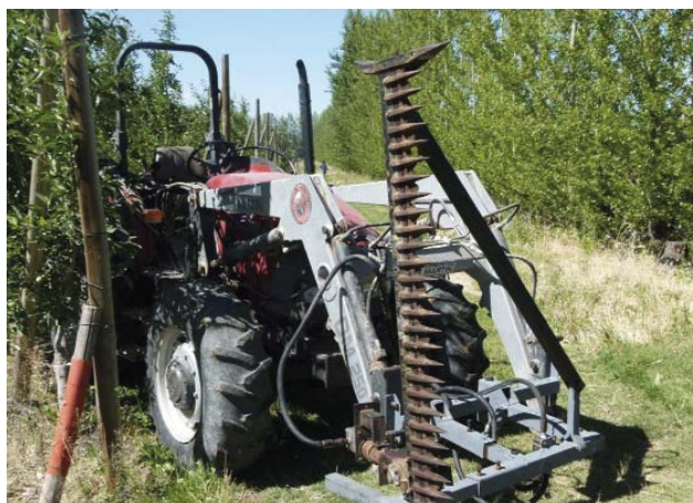
Foto 3. Prototipo de podadora mecánica para frutales.
