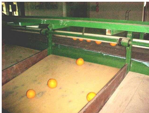
Figura 16: Tamañadora desarrollada por el Ing. Sastre del INTA y la firma Mousques en la década del `60.
