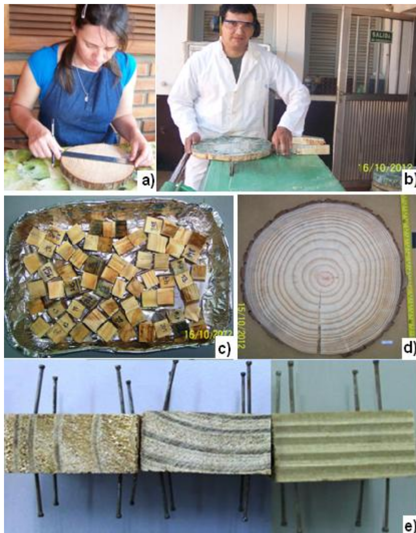
Figura A.2.5: Ensayos de propiedades físicas, a) medición de diámetro mayor y menor y marcación de probetas para densidad básica, b) preparación de probetas para densidad básica, c) muestras para densidad básica para ser llevadas a la estufa, d) rodaja para determinación de leño temprano y tardío, e) probetas para determinar contracción en los 3 planos de corte (axial, radial y tangencial).
