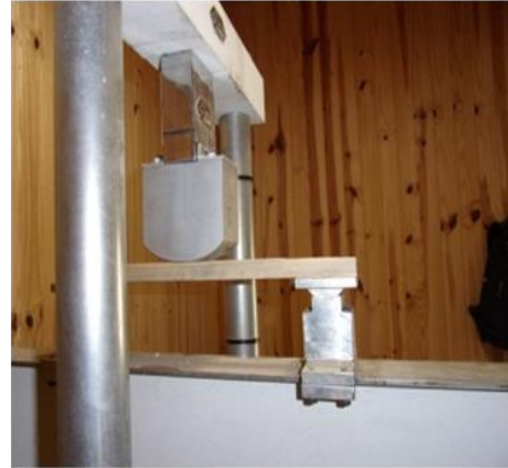
Figura 3.6: Esquema de ensayo de flexión estática en máquina universal
