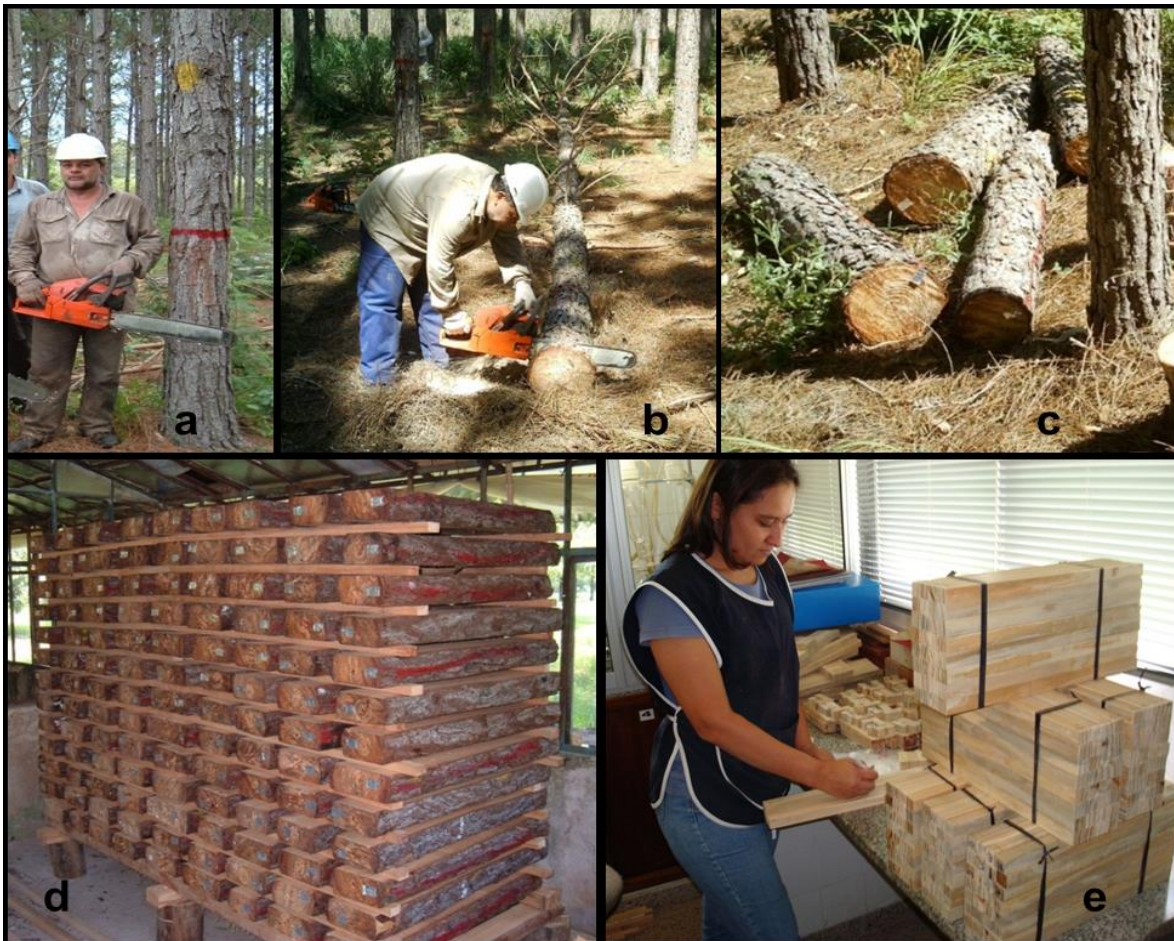
Figura 3.4: Pasos sucesivos para la obtención de probetas para determinación de ensayos mecánicos
