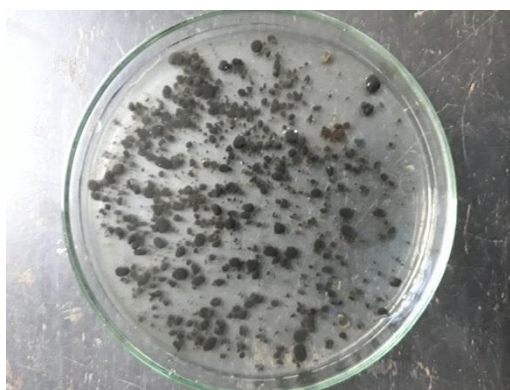
Figura 1. Lodo proveniente de una planta de jarabe de maíz. Puede observarse sus características granulares.
