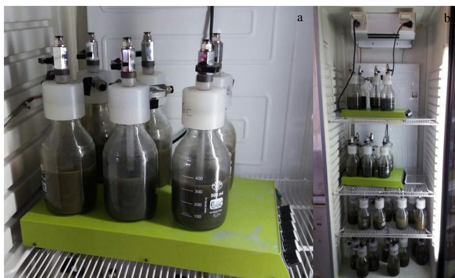
Figura 2. Condiciones experimentales. a) Reactores anaeróbicos en agitador magnético con 6 puertos; b) reactores anaeróbicos en incubadora regulada a 35°C.
