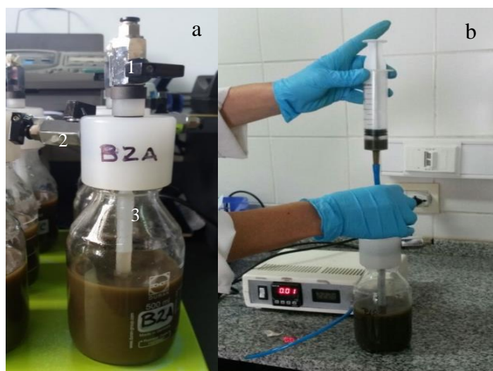
Figura 1. Nuevo diseño de reactor con muestreador de la fase líquida. a) Reactor anaeróbico, 1: válvula esférica conectada al muestreador; 2: válvula esférica conectada al headspace ; 3: tubo muestreador; b) reactor anaeróbico conectado a la jeringa para muestrear la fase líquida.
