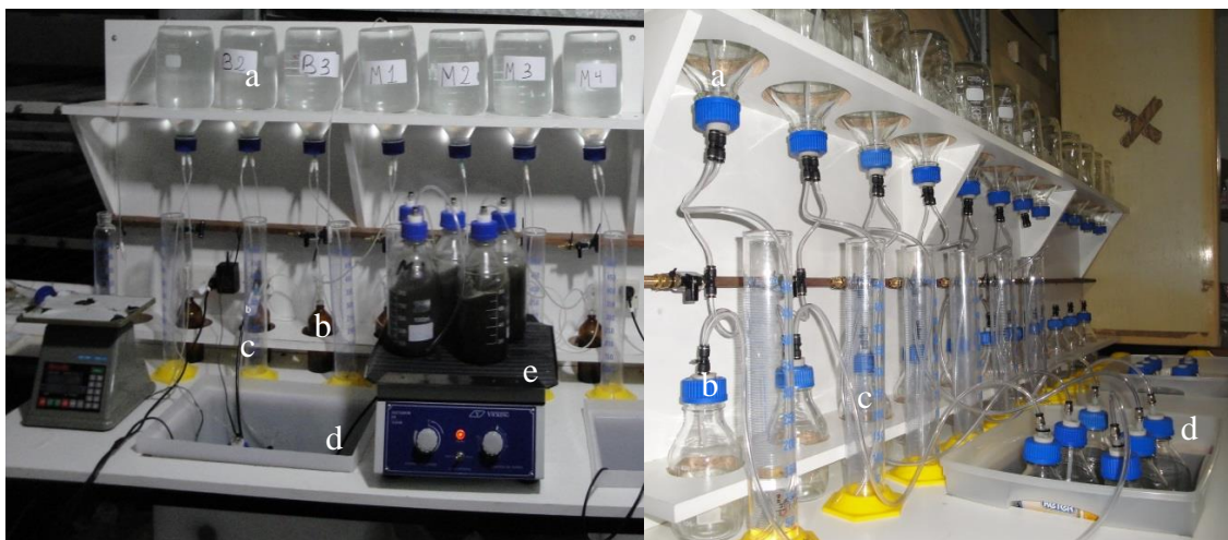
Figura 2. Primer diseño de sistema de reactores. a) botella con solución alcalina; b) trampa de agua; c) probeta para recolección del volumen desplazado; d) baño termostático e) agitador.
