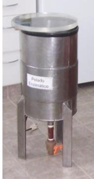
*Figura 4: Equipo experimental para el pelado de cítrico.*
