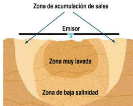
Figura 4. Distribución típica de sales en riego por goteo (Schilardi, 2015) Figure 4. Typical distribution of salts in drip irrigation (Schilardi, 2015)
