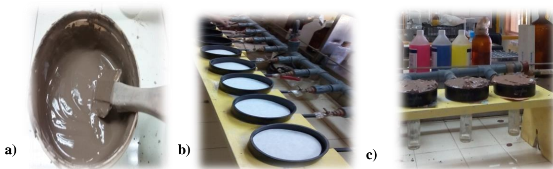
Figura 12. a) Muestra de suelo en estado de pasta de saturación b) Embudos de extracción conectados a bomba de vacío c) Obtención de extracto de saturación Figure 12 a) Soil sample in saturated paste b) Extraction funnels connected to vacuum pump c) Obtaining saturation extract
