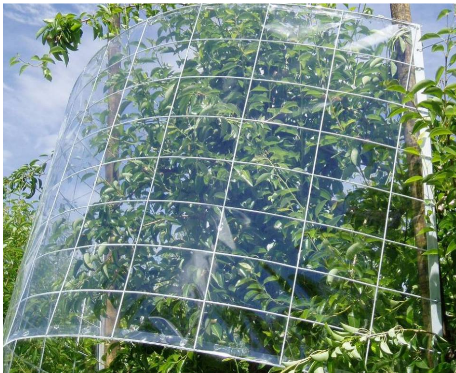
Fotografía 3.1. Vista de un bastidor con una película utilizada y que redujo la PAR sin ocasionar marcadas diferencias en la temperatura de los frutos.
