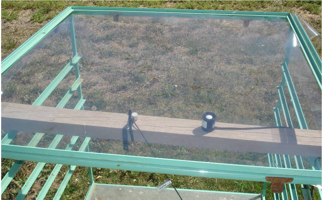
Fotografía 2.1. Bastidores y sensores de radiación PAR y UVB utilizados para determinar el porcentaje de radiación retenido por las películas Mylar-D y Stretch.
