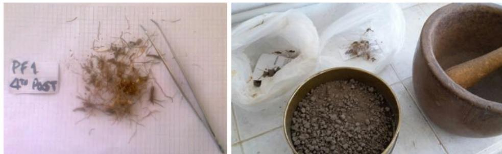
Figura 2.10: Porción de las raíces extraídas de una muestra (izquierda) e instrumental utilizado para la separación del suelo (derecha).
