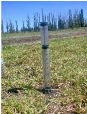
Figura 2.11: Infiltrómetro de mini disco.
