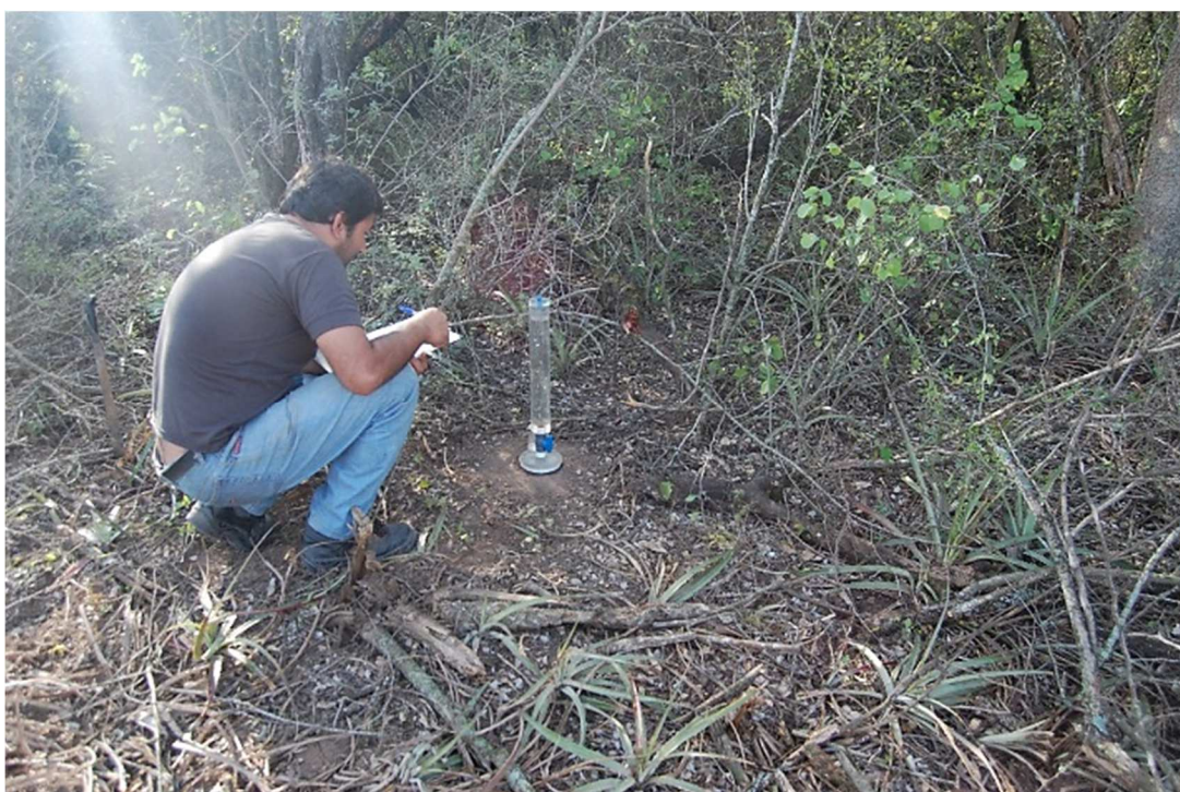
Determinación de infiltración en tratamiento de bosque.
