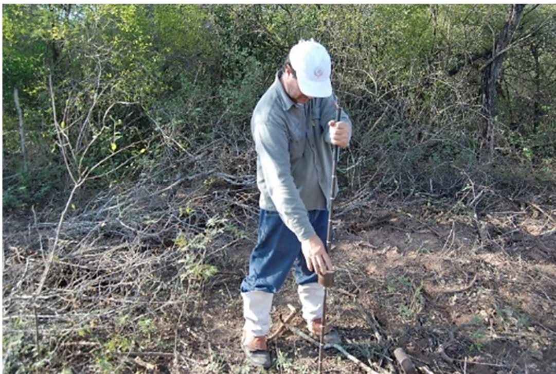
Determinación de resistencia mecánica a la penetración en tratamiento de bosque.
