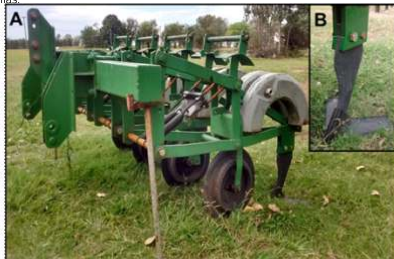
Figura 1: A.) Cultivador de reja plana utilizado en el experimento y B.) Detalle del timón y cuchillas.
