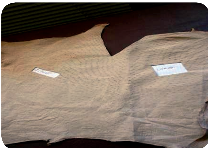
Foto 4. Cuero semiterminado sin tintar. El color es el propio del proceso de curtición y de los recurtientes vegetales.
