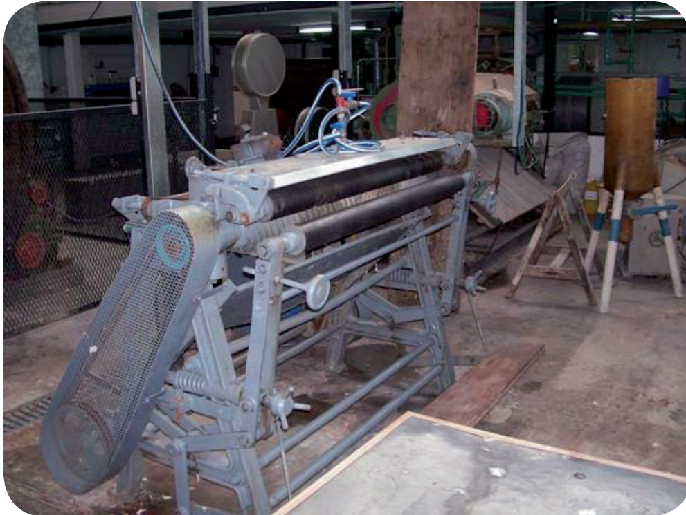
Foto 2. Máquina de descarnar de rodillo, para pieles medianas y pequeñas.
