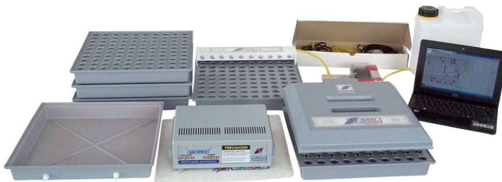
Figura 1.25. Equipo de conductividad eléctrica de semillas individuales SAD 9000-S.
