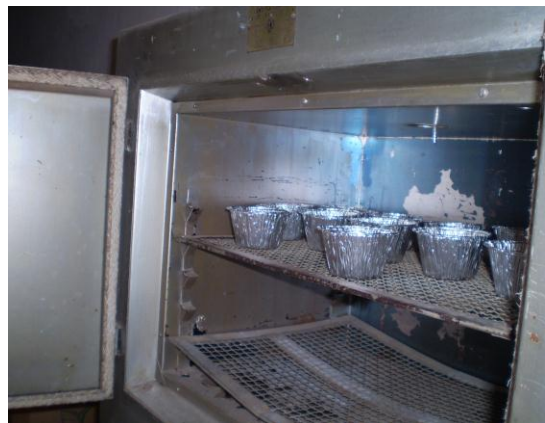
Figura 1.6. Repeticiones de cada lote de maíz en la estufa de secado.
