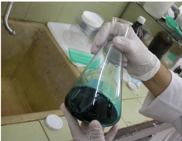
Figura 1.8. Cariopses de maíz sumergidos en la solución de Fast Green .
