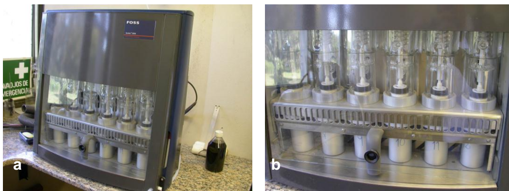
Figura 3.11. a) Equipo extractor Soxtec TM 2050 utilizado para determinar Lípidos. b) detalle de vasos de aluminio con los cartuchos de fibra vegetal en su interior.
