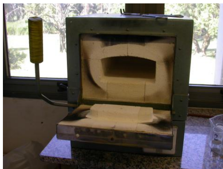
Figura 3.7. Mufla utilizada para la ejecución del análisis.
