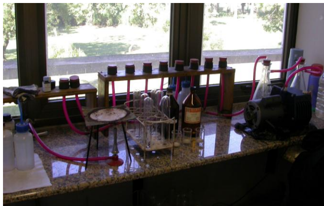
Figura 3.10. Equipo Van Soest para la determinación de Fibras totales.
