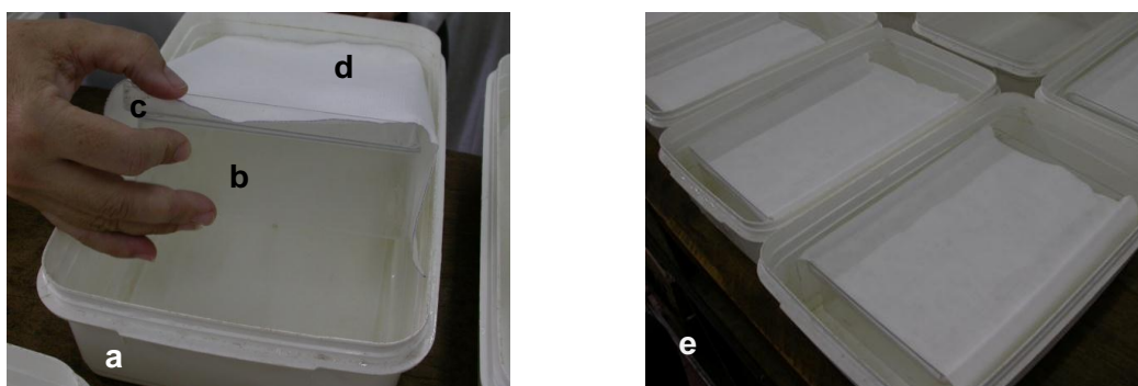
Figura 2.16. Sistema artesanal para la Prueba de frío saturada. a) Caja mayor, b) caja menor transparente, c) caja playa y d) hoja de papel que se embebe con agua y satura el sustrato. e) batería de cajas armadas.
