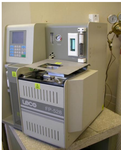
Figura 3.9. Equipo LECCO utilizado para la determinación de Proteínas.
