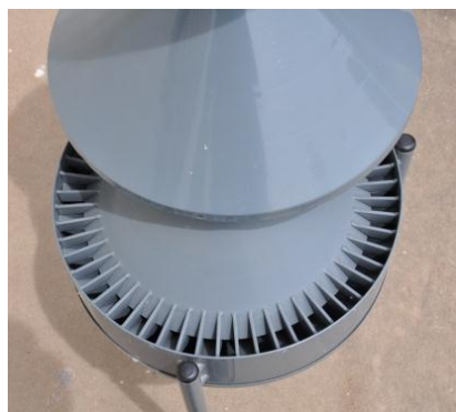
Figura 1.3. Vista interna de las partes constituyentes del Divisor tipo Boerner.
