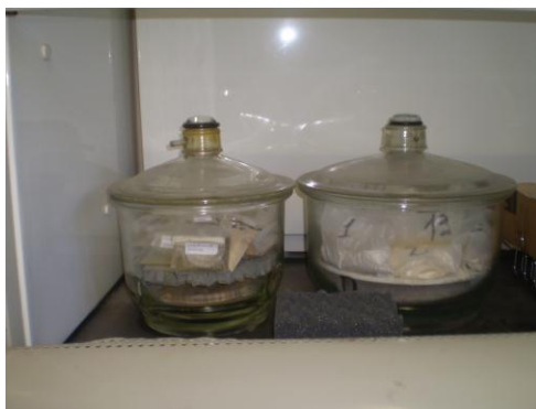
Figura 3.5. Desecadores con muestras de cariopses de maíz.
