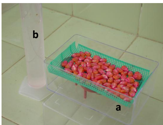
Figura 2.9. Mini cámara de Envejecimiento acelerado. a) Caja de acrílico con soporte y cesta con los cariopses. b) Probeta para medir el volumen de agua que se incorpora a la mini cámara.
