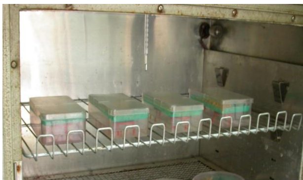
Figura 2.11. Vista interna de la estufa de incubación con las mini cámaras dispuestas en su interior.
