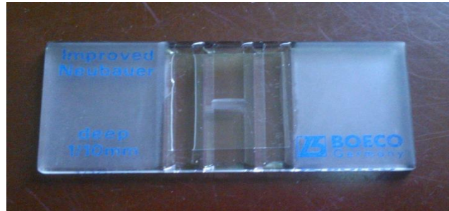
Figura 4. Cámara de Neubauer.
