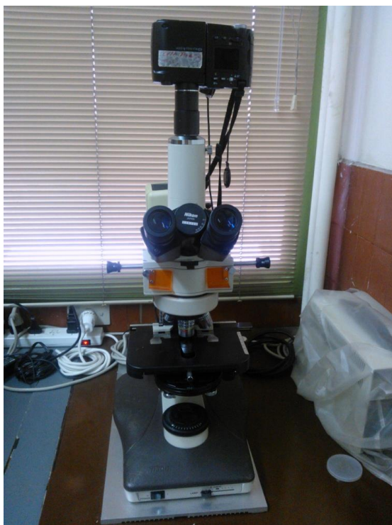
Figura 7. Microscopio Nikon Labophot-2 provisto de cámara fotográfica digital.
