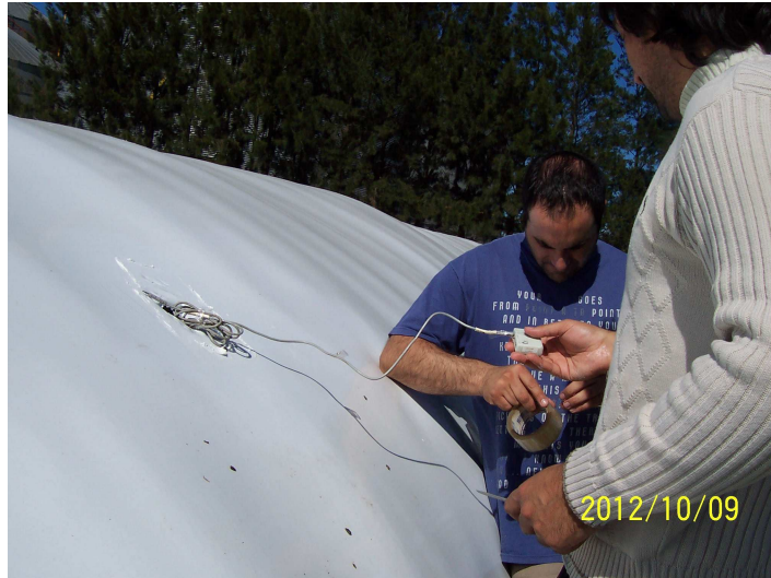
Figura 5. Vista lateral del silo bolsa con sensores. Los datos de cada sensor se registraron en dataloggers colocados en el lado exterior de la bolsa, que permanecieron durante todo el p.e.
