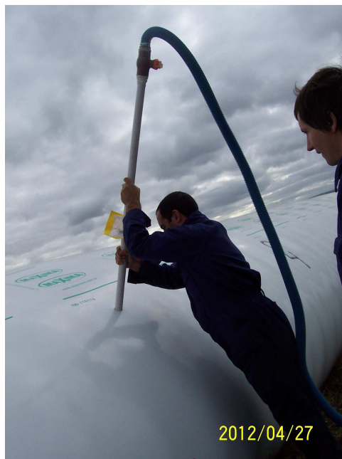
Figura 9. Vista lateral del silo bolsa. El tubo de succión, de PVC de 50 mm de diámetro y 1,6 m de longitud, inserto en el centro de la bolsa.
