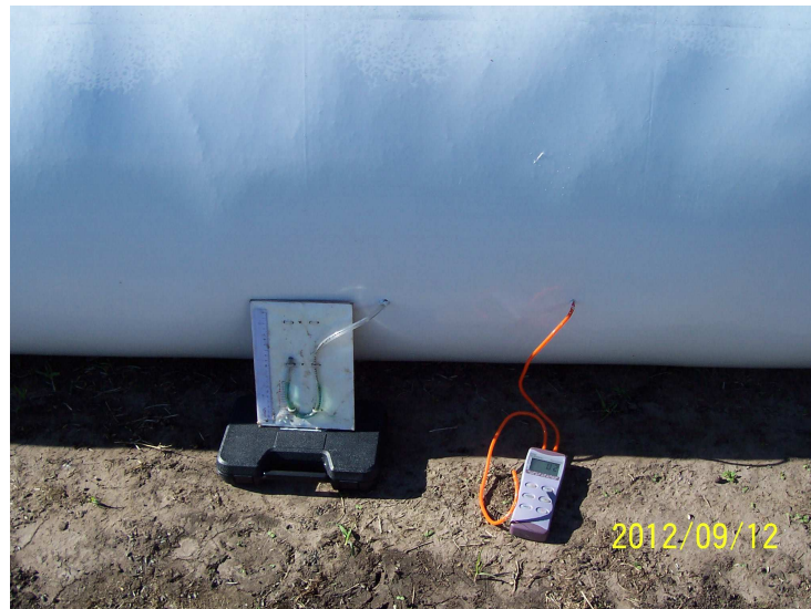
Figura 14. Manómetro digital (derecha) y de columna de agua (izquierda), utilizados para medir la presión que se generó en el interior de la bolsa.
