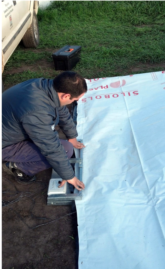
Figura 16. Extremo anterior de la bolsa antes del embutido, cuando se practica el termosellado.
