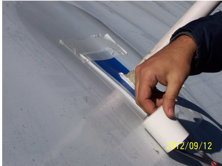
Figura 12. Vista lateral del silo bolsa, sección de plástico flexible y tubo de succión. Para evitar fugas, la sección de plástico flexible se pega a la bolsa con cinta aislante y el tubo de succión se sella a la sección de plástico con silicona.
