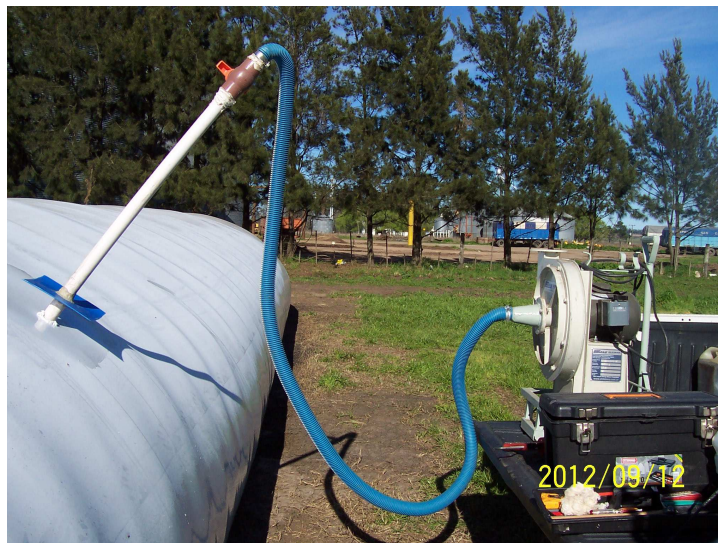
Figura 13. Silo bolsa con tubo de succión. El otro extremo del tubo de succión se conecta mediante una manguera flexible a un generador de vacío, entre el tubo y la manguera hay una válvula de cierre.
