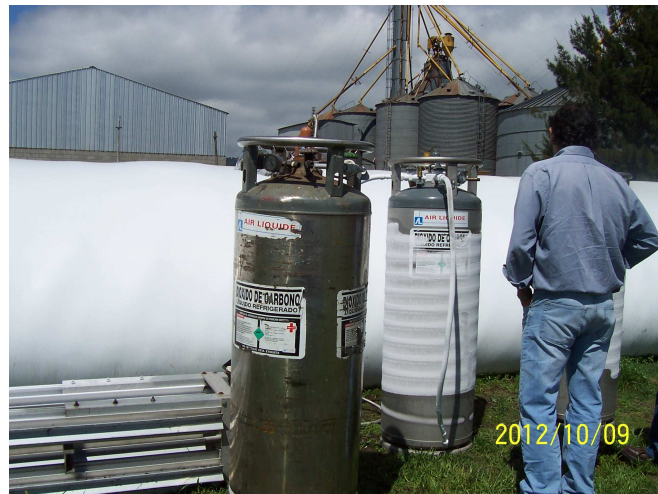
Figura 19. Vista lateral de la bolsa. Delante, tubos de CO 2 y gasificados. La función del gasificador es pasar el CO 2 de líquido a gaseoso.
