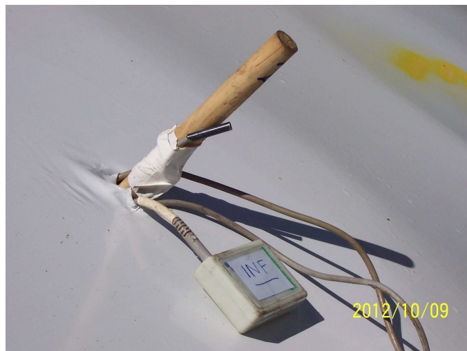
Figura 4. Vista lateral del silo bolsa con sensores de temperatura que se colocaron sobre una barra de madera.
