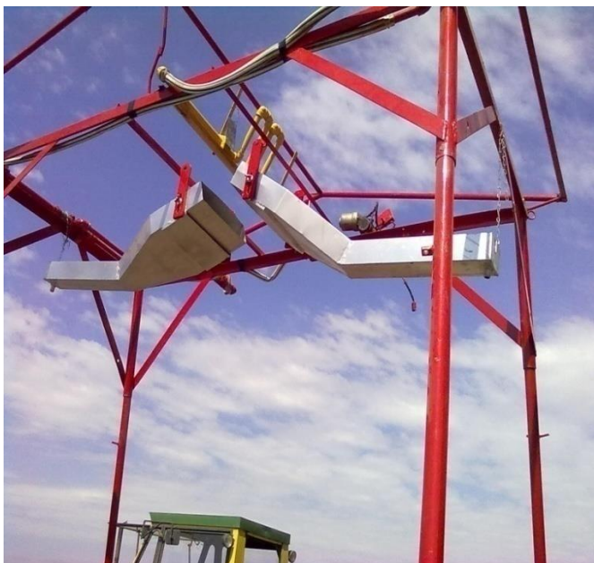
Foto 19. Detalle de bastidor, embudos y barra oscilante portapicos, con vaivén generado por un motor eléctrico
