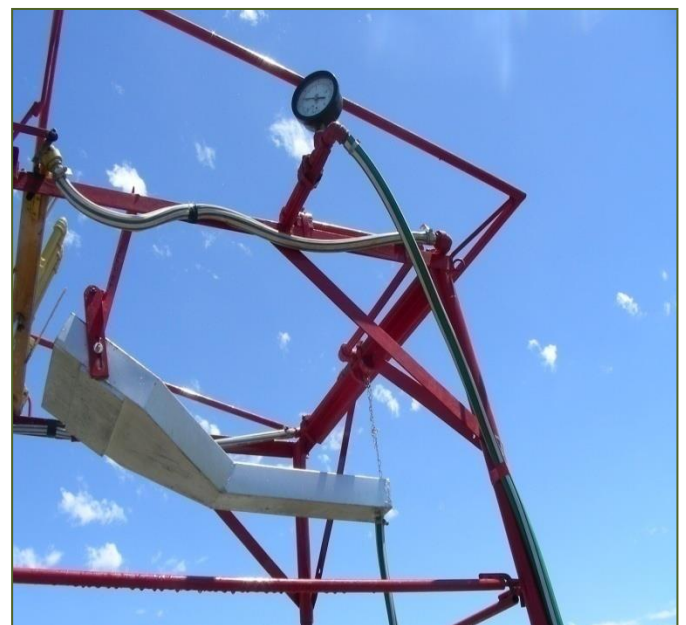
Foto 20. Detalle de embudo colector y manómetro que controló la presión de trabajo
