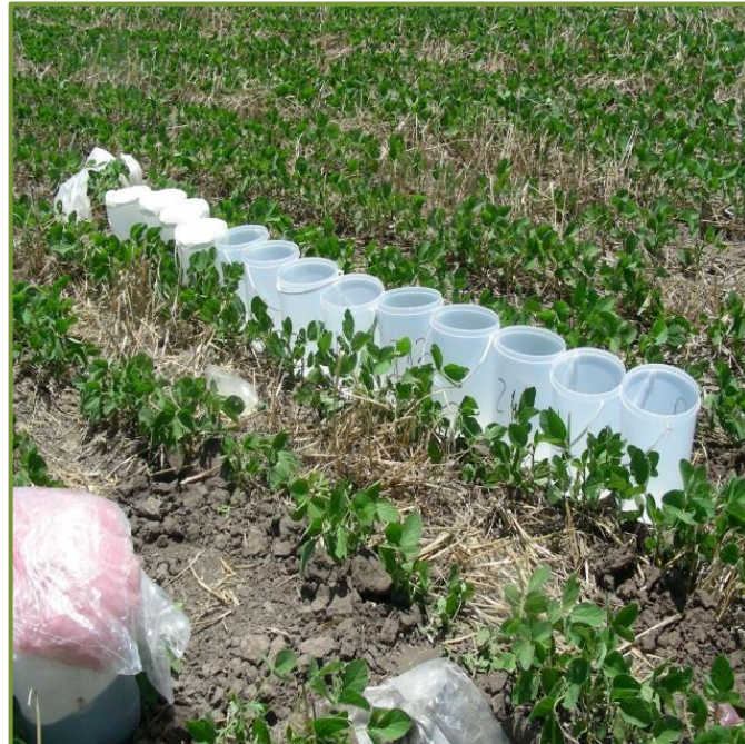
Foto 24. Serie de 13 baldes colectores de escurrimientos para cada lluvia simulada
