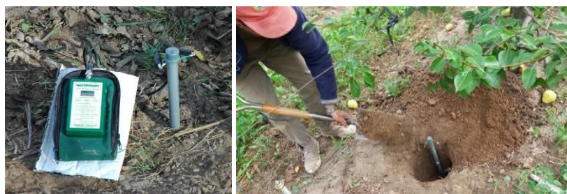
Fotos N° 4 y 5: instrumento de medición e instalación de sensor de humedad de suelo.
