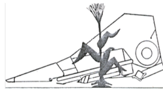
Figura 2: espigado en la parte media del recorrido de los rolos
