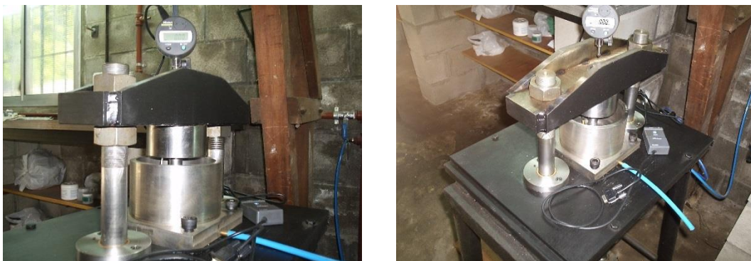
FIGURA 2.2: Comparador centesimal para medir deformación de la muestra de suelo. Puede verse la interfase para conexión a PC.
