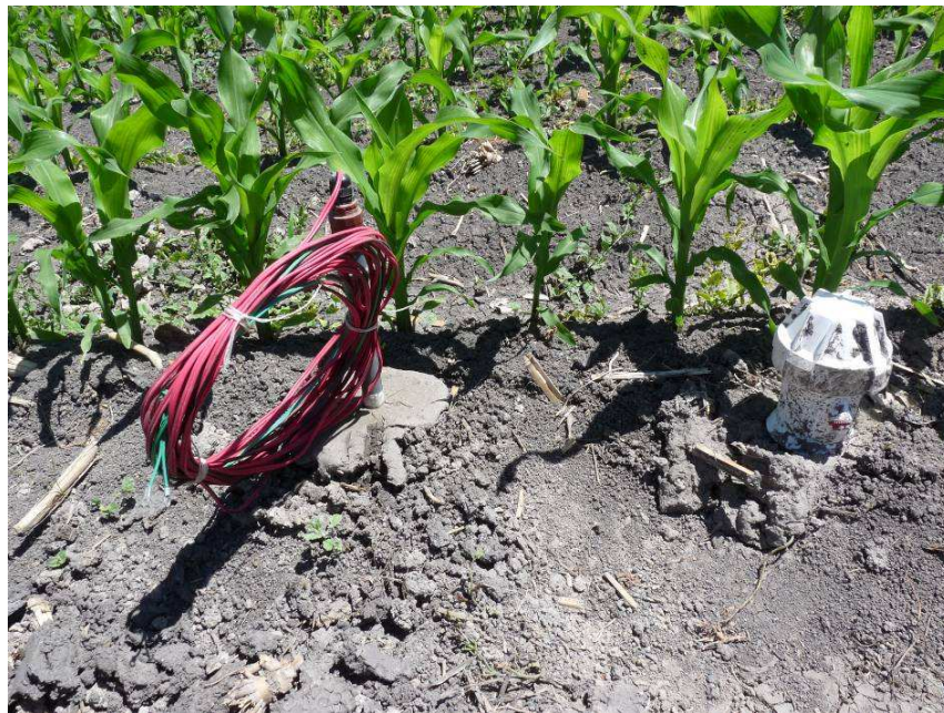
Fotografía 3. Vista del cultivo de maíz con los sensores Watermark® (izquierda) y Diviner® (derecha) instalados.
