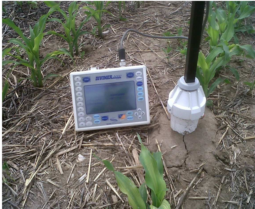
Fotografía 4. Equipo Diviner® instalado para el seguimiento de la humedad volumétrica por capacitancia.
