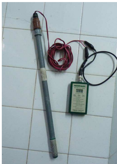
Fotografía 1. Sensor Watermark® 200SS y medidor (30KTCD) modificado para su lectura desde fuera de las parcelas de riego.
