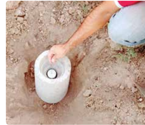
FOTO 07.c Base de hormigón y tapa plástica.
