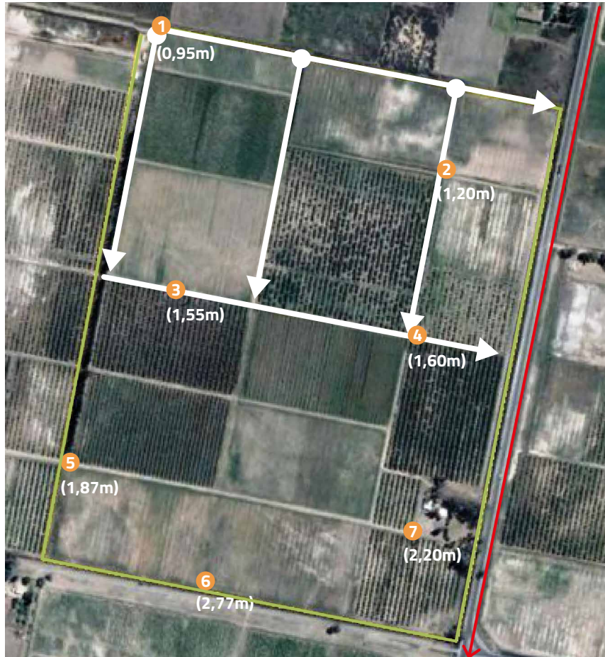
Fig. 10 Trazado del sistema de drenaje parcelario.
