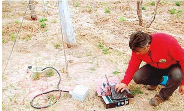
FOTO 09 Determinación de conductividad hidráulica en un freático.
