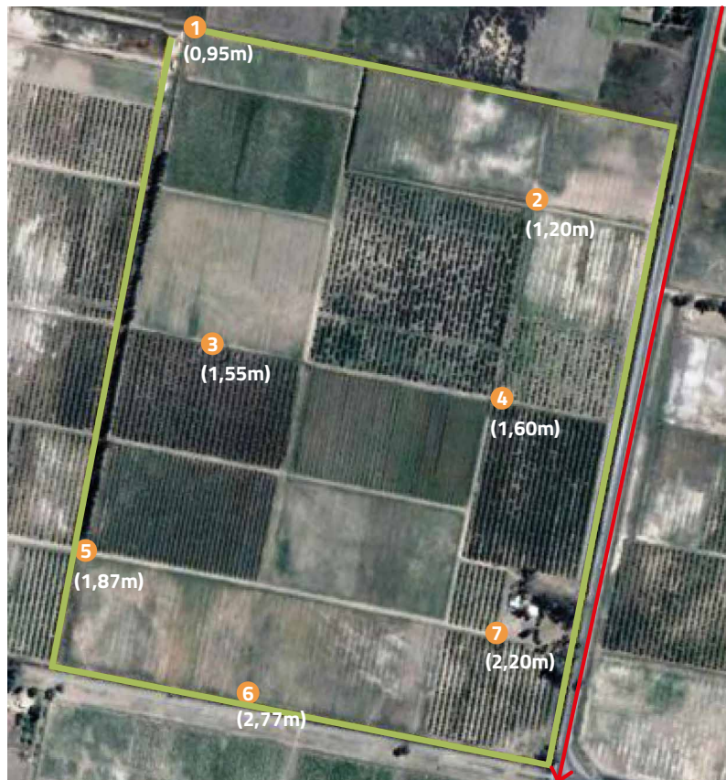
Fig. 07 Lectura en una red de frea'tímetros instalados en una propiedad.
