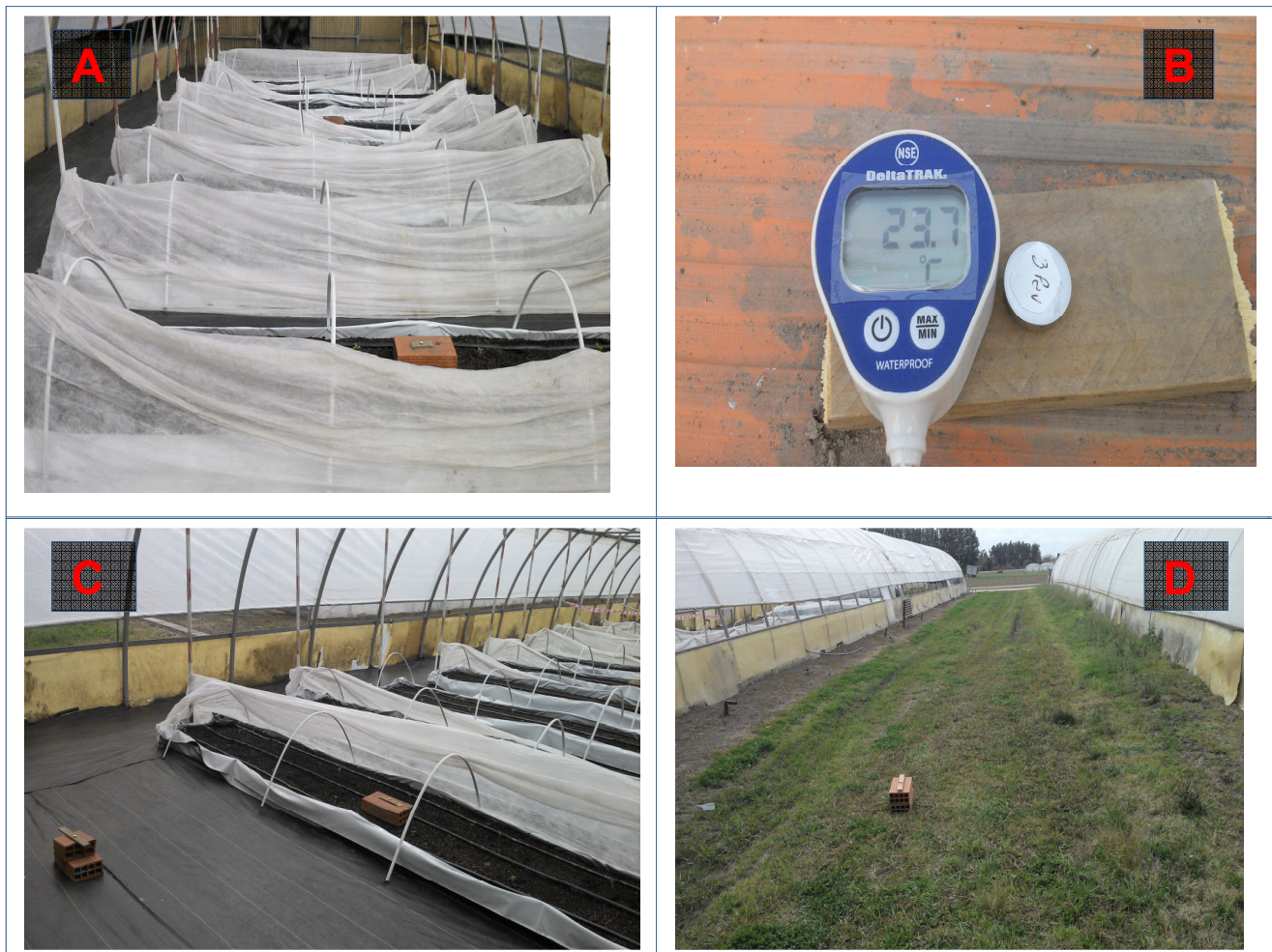
Figura 2. Data logger ubicados en los diferentes ambientes. A) Detalle de la manta térmica y los data logger en la línea de cultivo. B) Data logger Thermobutton y Termómetro digital usado para monitorear la temperatura. C) Sensores dentro y fuera de la línea de cultivo. D) Registro de la temperatura en el exterior del invernadero
