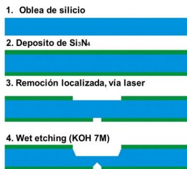
Figura 1: Ilustración esquemática de las etapas iniciales del proceso de formación de poros. 1.1) Oblea de silicio, 1.2) Oblea de silicio con deposición de nitruro de silicio, 1.3) Remoción localizada de nitruro de silicio y 1.4) Wet etching con KOH 7M.
