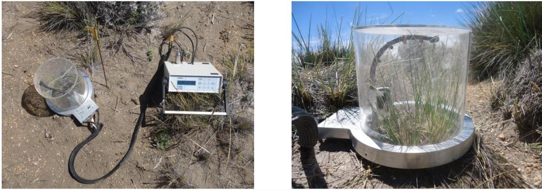
**Figura 3.1.** Instrumental utilizado para medir el intercambio neto de CO<sub>2</sub> del ecosistema: cámara transparente conectada al analizador de gases infrarrojos (Modelo EGM-4, PP Systems).
